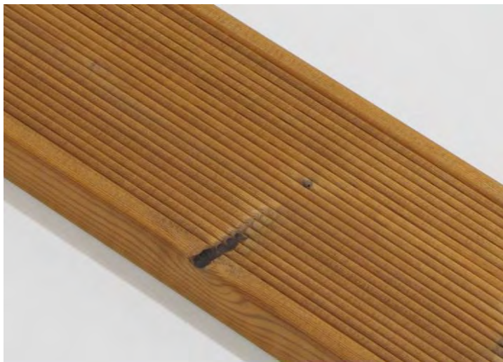
Osamocený chybějící suk do šíře 15 mm je povolen.
