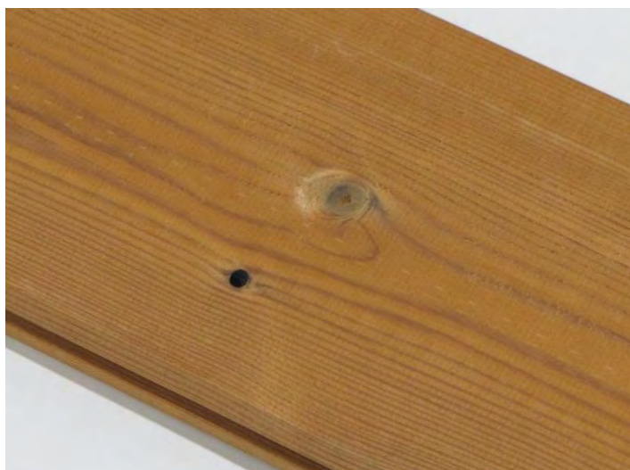
Díry (ne skrz) po vypadlém suku do 15 mm jsou povoleny.
